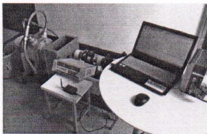
图 8 差速泵转矩特性试验台
